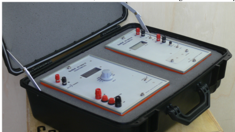
Figura 30 – Resistivímetro RD-1000A, utilizado no levantamento geofísico da área pesquisada
