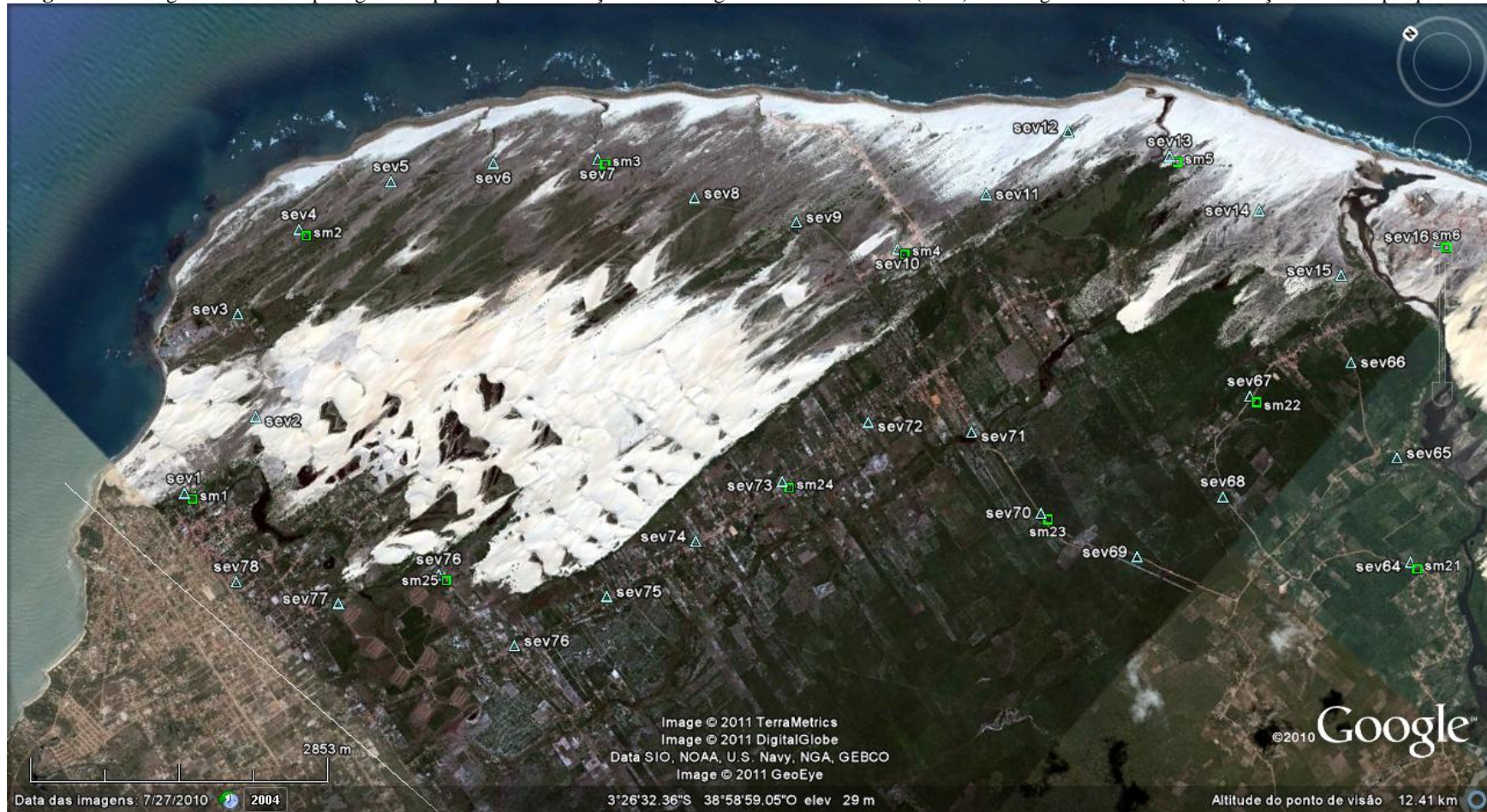
Figura 34 – Imagem orbital com plotagem dos pontos para realização das sondagens elétricas verticais (SEV) e sondagens mecânicas (SM) – seção 1 da área pesquisada
